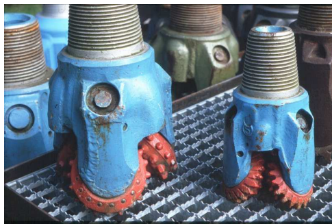
(Bild 1: Erdöl-Bohrmeißel mit je 3 gezähnten Kegelrollen)
