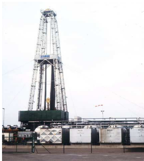
(Bild 3: Erdölbohrturm mit Rohrgestängeabschnitten, daneben Behälter für die Bohrflüssigkeit)
